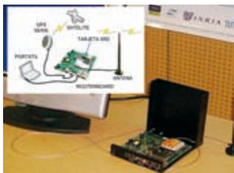
Figura 7. Módulo de comunicaciones V2V de Telefónica I+D en COM2REACT
